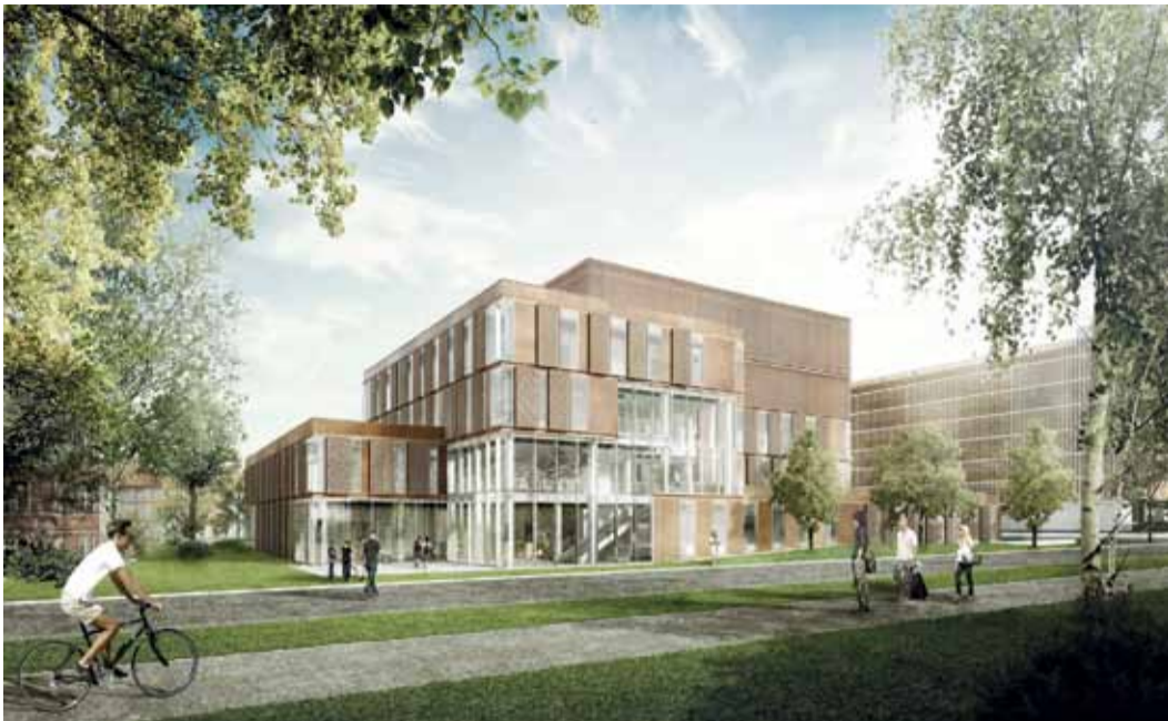
Bygningen bliver beklædt med anodiseret aluminium. Ved vinduerne sidder plader i hullet strækmetal, der kan køre frem og tilbage som solafskærmning. Illustration: Mikkelsen Arkitekter, WHR Architects og Alecia.
